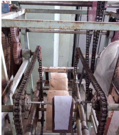
Рис. 2. Валковый стэнд с металлокерамической опорной плитой
