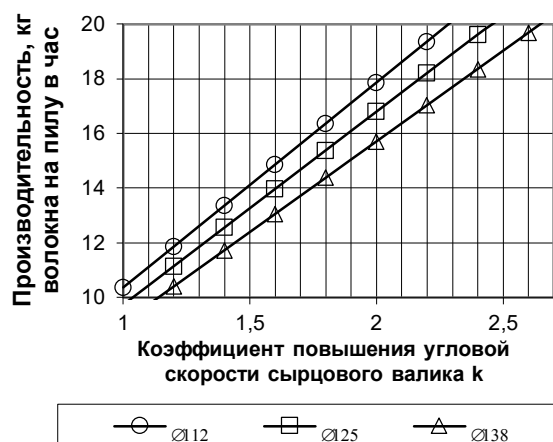
Рис. 2. Изменение расчетной производительности пильного джина с шелушильной камерой и семяотводящей системой в зависимости от коэффициента увеличения угловой скорости сырцового валика при различных диаметрах трубы
