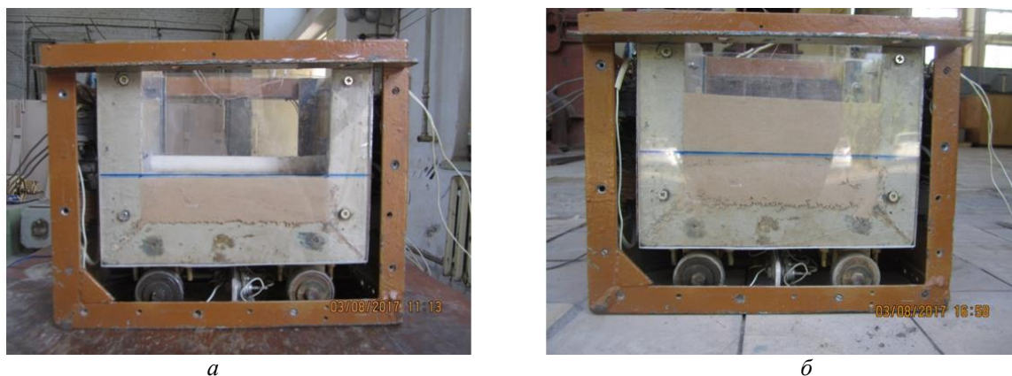
Рис. 4. Изображение контейнера с платформой и расположенной внутри грунта исследуемой моделью
