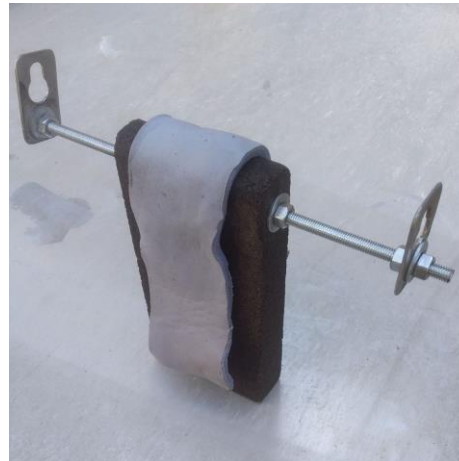
Рис. 3. Мокрый кожевенный полуфабрикат (образец), повешенный вперегиб на металлокерамическую опорную плиту
